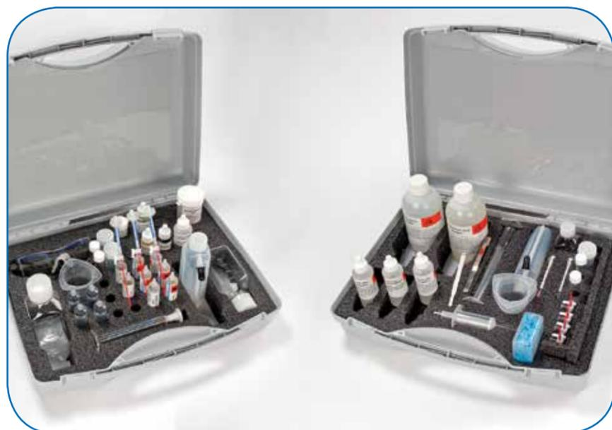
**56K002001:** Resin Fouling Test Kit
